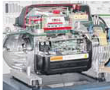
Das 1:1-Schnittmodell eines ölfreien, magnetgelagerten Verdichters ist unter anderem zurzeit im Foyer des Landratsamts zu besichtigen. Foto: privat
